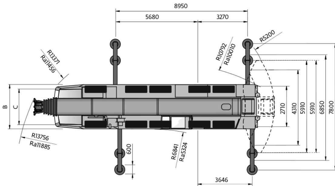
*Ra = Radius all wheels steered • Radius allradgelechts • Rayon toutes les roues directrices • Radio de giro con todas las ruedas giradas • Raggio di curva con tutte le ruote sterzate
